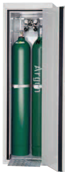
TRG.205.60/C armoire pour 2 bouteilles de gaz 50 l. avec aménagement standard (rails de fixation, sangles de maintien, rampe d'accès escamotable). L x P x H (mm) : env. 600 x 615 x 2050 Poids (kg) : env. 290
