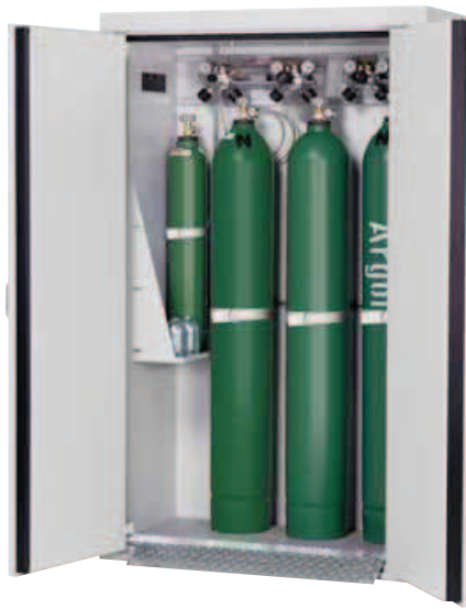
TRG.205.120/C armoire pour 4 bouteilles de gaz 50 l. avec aménagement standard (rails de fixation, sangles de maintien, rampe d'accès escamotable). L x P x H (mm) : env. 1200 x 615 x 2050 Poids (kg) : env. 470
