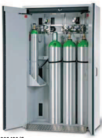
G90.205.120/C armoire pour 4 bouteilles de gaz 50 l. avec aménagement standard (rails de fixation, sangles de maintien, rampe d'accès escamotable). L x P x H (mm) : env. 1200 x 615 x 2050 Poids (kg) : env. 485
