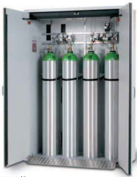
G90.205.140/C armoire pour 4 bouteilles de gaz 50 l. avec aménagement standard (rails de fixation, sangles de maintien, rampe d'accès escamotable). L x P x H (mm) : env. 1400 x 615 x 2050 Poids (kg) : env. 525
