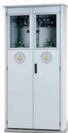
LG.215.100 armoire pour 3 bouteilles de gaz 50 l. avec aménagement standard (rails de fixation et sangles de maintien), porte-documents et 2 fenêtres de visualisation ouvrables. L x P x H (mm) : env. 1000 x 400 x 2150 Poids (kg) : env. 113
