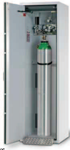
G90.205.60/C armoire pour 1 bouteille de gaz 50 l. avec aménagement standard (rails de fixation, sangles de maintien, rampe d'accès escamotable). L x P x H (mm) : env. 600 x 615 x 2050 Poids (kg) : env. 305
