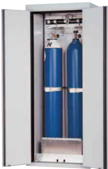
TRG.205.90/C armoire pour 3 bouteilles de gaz 50 l. avec aménagement standard (rails de fixation, sangles de maintien, rampe d'accès escamotable). L x P x H (mm) : env. 900 x 615 x 2050 Poids (kg) : env. 340
