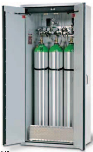
G90.205.90/C armoire pour 3 bouteilles de gaz 50 l. avec aménagement standard (rails de fixation, sangles de maintien, rampe d'accès escamotable). L x P x H (mm) : env. 900 x 615 x 2050 Poids (kg) : env. 350
