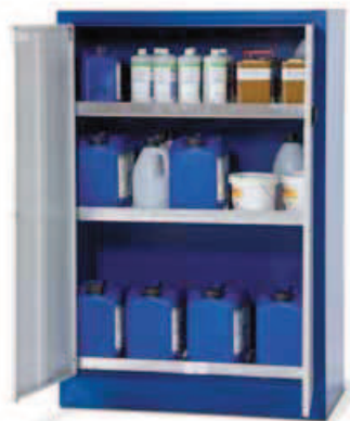
U.130.95 armoire d'environnement avec 2 bacs de rétention galvanisés comme étagères et 1 bac de rétention galvanisé. L x P x H (mm) : env. 950 x 500 x 1400 Poids (kg) : env. 60
